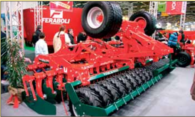
Tanierový podmietač TerraDisc pro od Vogel Noot určený aj do ťažkých pôd a na dobré miešanie rastlinných zvyškov s pôdou sa bude dodávať s rôznymi šírkami a rôznymi typmi valcov.
