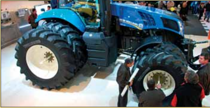
New Holland vystavil nové T8-kové modely s výkonom na hranici 400 k. Osa- dené budú mať motory Cursor 9,6 valcové so 4 ventilovou technikou s SCR. Nominálny výkon 340 k/ 250 kW pri 2 200 otáčkach sa navyšuje na max. 389 k/ 286 kW. Na výber bude zo 4 možností prevodoviek vrátane bezstupňovej.
