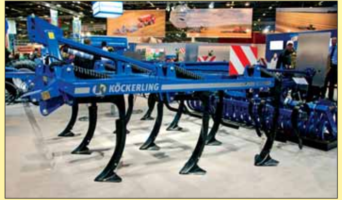
Köckerling Trio – radličkový kyprič so svetlou výškou rámu 85 cm a s STS valcom.
