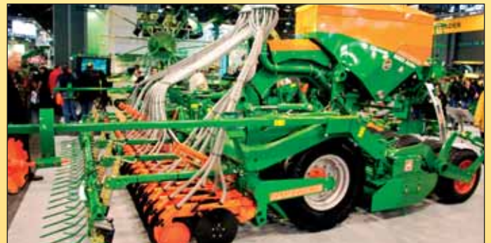
Amazone predstavila vynovené sejačky s Roller Drill System – RDS. Osivo sa ukladá presne do rýh utužených utlačovacími valcami. Výsevné pätky tvoria dvojkotúčové RoTeC-Control, za ktorými nasleduje exaktný zavlčovač, alebo zavlčovač tesne nasledovaný utlačovacími kotúčmi.
