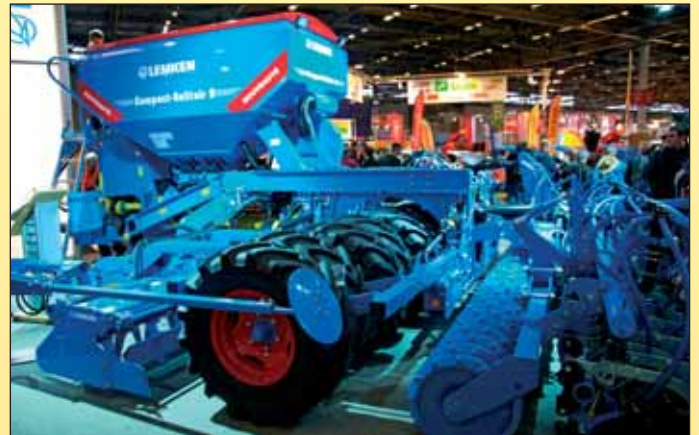
Lemken si pravdepodobne svoje tromfy v oblasti noviniiek nechal na nemeckú Agritechnicu. Na snímke kombinácia Solitair 9 s rotačnými bránami.
