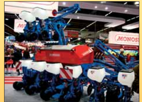
Novinky francúzskeho výrobcu Monosem sa týka- li posunu výsevných jednotiek na ráme pre rôznu medziriadkovú vzdialenosť a zloženia strojov na prepravnú šírku 3 m.
