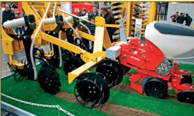
Strip-Sem od Agrisemu – kombinácia podrývania, prihnojovania a sejačky na presný výsev.
