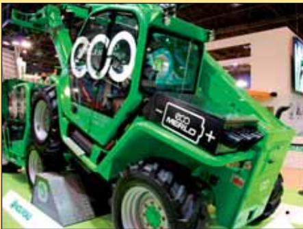
Hybridné pohony sa už netýkajú len osobných automobilov, ale aj teleskopických manipuláto- rov. Merlo prišlo na výstavu s modelom Panor- amic P 4.17 HY. Ale zväčšilo aj modely Multifarmer.
