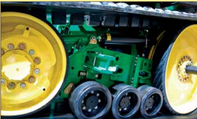
John Deere predstavil aj nový pásový podvozok so zavesením na vzduchových vankúšoch, určený pre 8RT modely.
