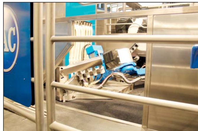
Jedno robotické rameno RDS Futureline je určeno pro obsluhu dvou dojících boxů
